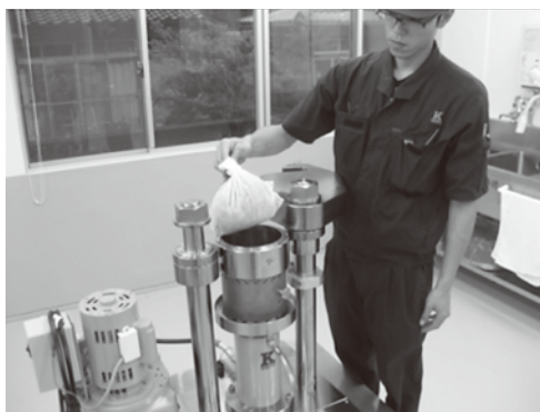
搾油作業(直圧式電動搾油機:KT50-160)
