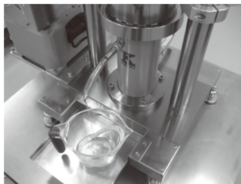
搾油作業(直圧式電動搾油機:KT50-160)
