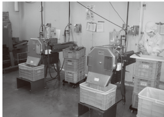
カット作業の機械化
